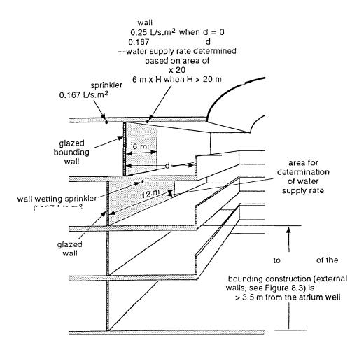
FIGURE 8.5 SPRINKLER REQUIREMENTS FOR GLAZED WALLS
