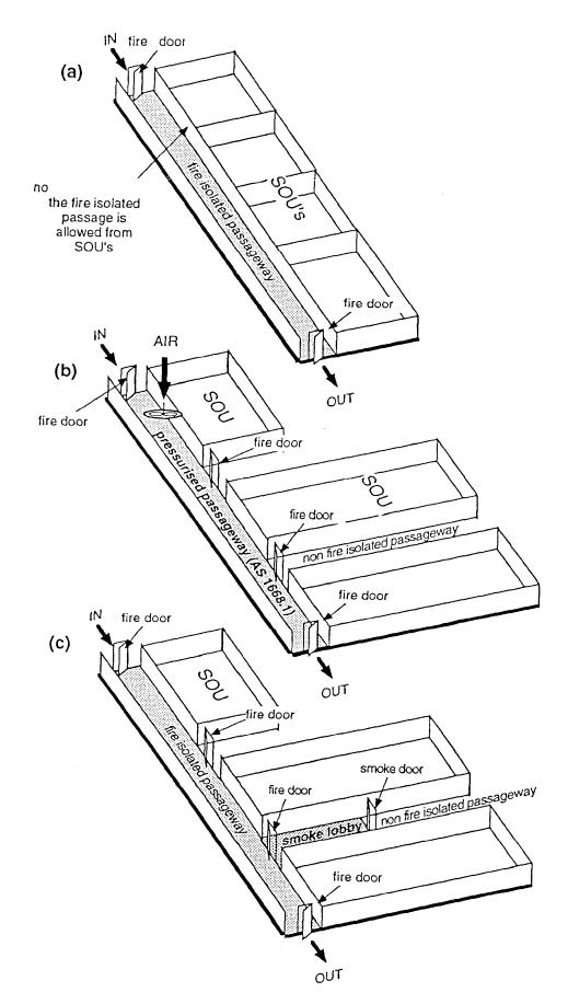
FIGURE 5.4 FIRE ISOLATED EXITS
